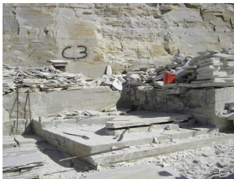
Figura 2: Extração das placas de quartzito
